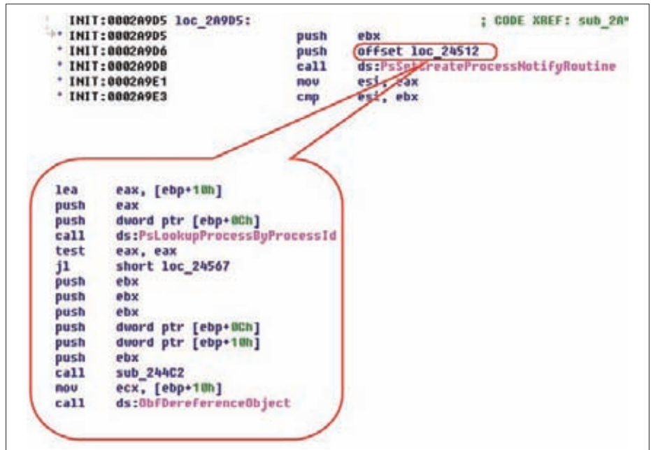
Рисунок 9. Использование PsSetCreateProcessNotifyRoutine в DrWeb для контроля над созданием процессов
